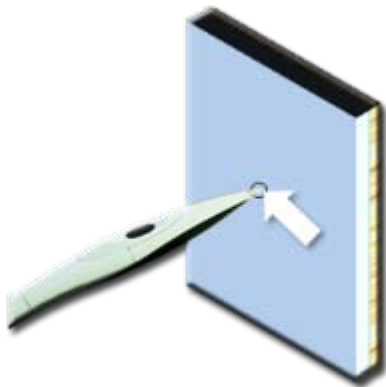
Imagen 2.9 Tocar con el ActivPen en la pizarra equivale a un clic. Simplemente tocando la punta del ActivPen en cualquier enlace, opción de menú o el icono que desea activar. Trasladando el ActivPen mientras presiona sobre un objeto adecuado o barra de desplazamiento equivale a arrastrar.
